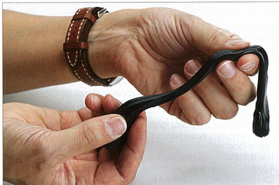
Ilma ise nägemata on raske uskuda APSi omadusi. Tavaolekus on ta kui pehme voolimisvaha. Kui sama materjal saab piisavalt tugeva löögi, muutub ta kõvaks kui hokilitter, kaitses riietuses paigutatuna kasutajat.
