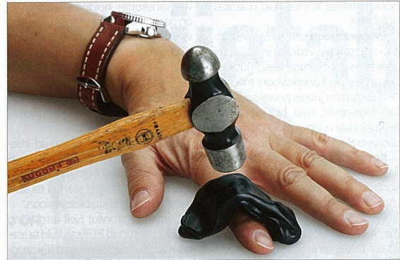
Ilma ise nägemata on raske uskuda APSi omadusi. Tavaolekus on ta kui pehme voolimisvaha. Kui sama materjal saab piisavalt tugeva löögi, muutub ta kõvaks kui hokilitter, kaitses riietuses paigutatuna kasutajat.
